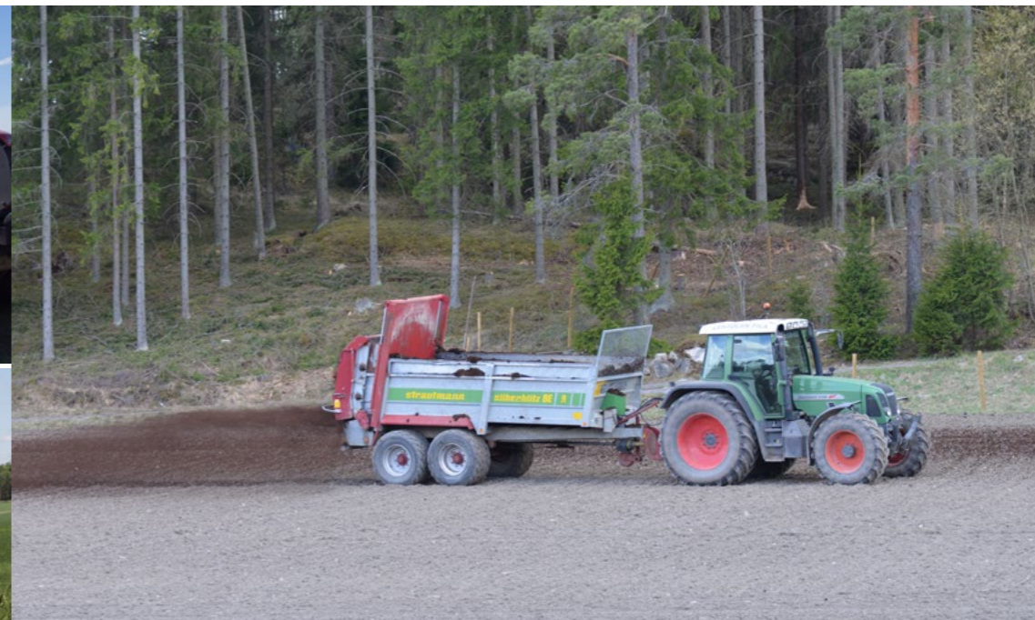
Kuivalannan tarkkuuslevitin tekee tasaista jälkeä, koska repijäkelat hienontavat massan levityslautasille.
